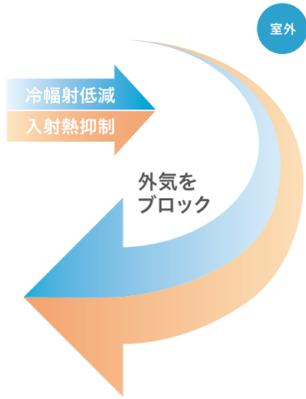
複層ガラスは2枚のガラスの間に空気の層を作ります。冬は室内からの熱損失を抑制、夏は冷房負荷を大きく軽減します。
